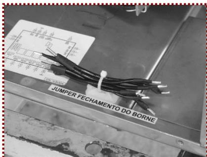
3- Retire os Jumpers de fechamento do borne, presos ao fixador adesivo que está colado abaixo do comando, na base da lavadora.
